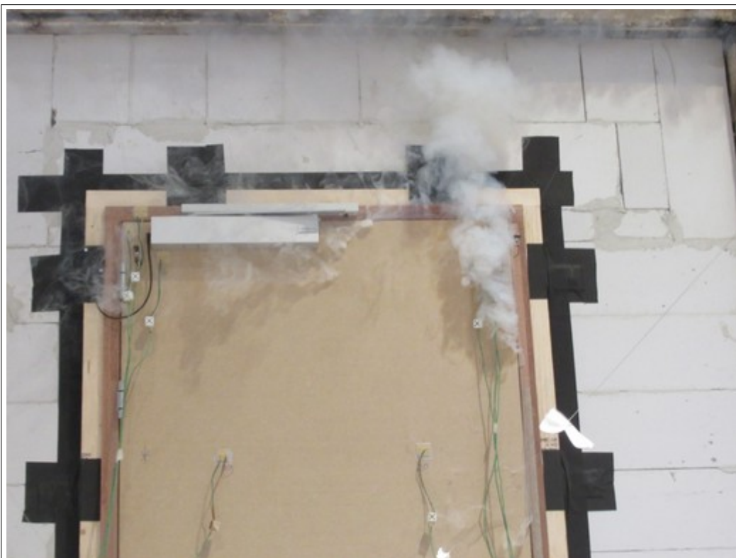
Foto 4: Beproeving na 2 minuten, rookontwikkeling deur B
