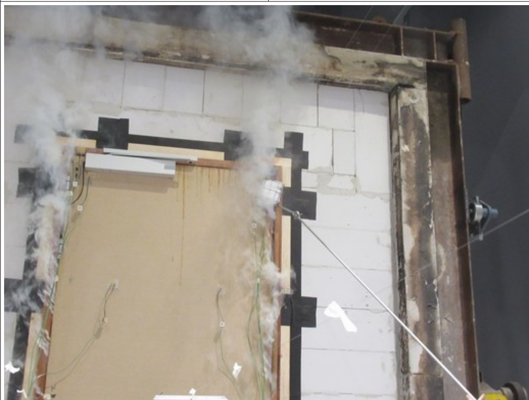
Foto 8: Beproeving na 34 minuten, wattenkussen rechtsboven sluitzijde deur B
