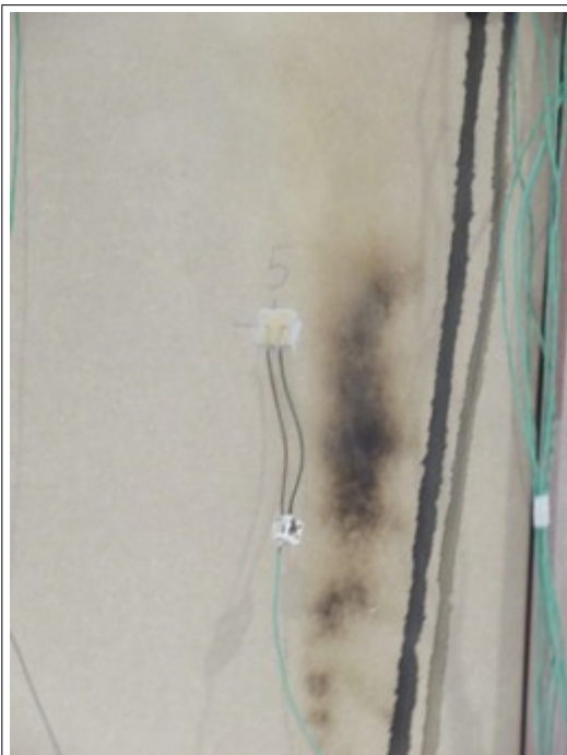
Foto 9: Beproeving na 41:43 minuten, zwarte verkleuring op deurblad deur A
