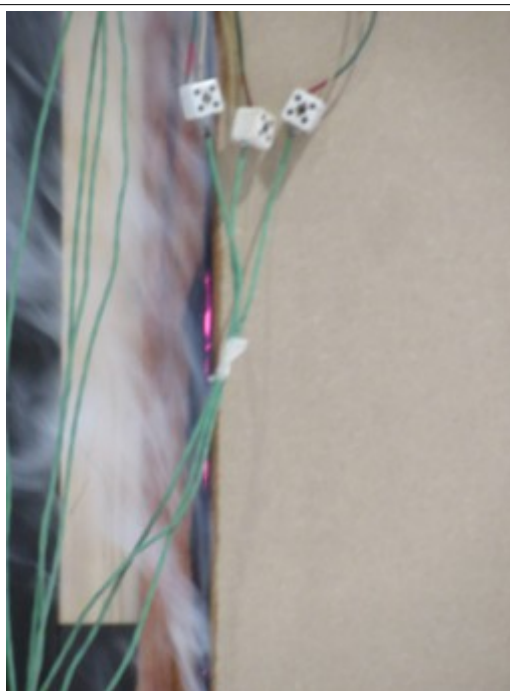
Foto 10: Beproeving na 42:54 minuten, gloeinaad zichtbaar scharnierzijde deur B
